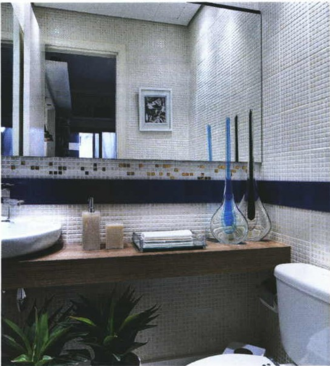
O lavabo, com apenas 2 m², tem um aérea leve com toques de cor. A bancada de MDF, revestida com folhas de madeira, abriga uma cuba de louça branca. Nas paredes, pastilhas de cerâmica se misturam às de inox douradas, iluminadas pelos spots embutidos no gesso. Os pontos estratégicos de cores destacam-se pelo minimalismo na medida, proporcionando a sensação de um espaço amplo
